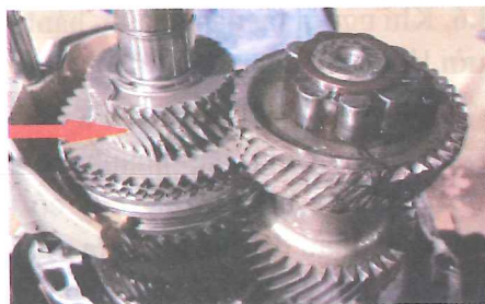
Hình 6.13. Bánh răng của hộp số bị xứt
