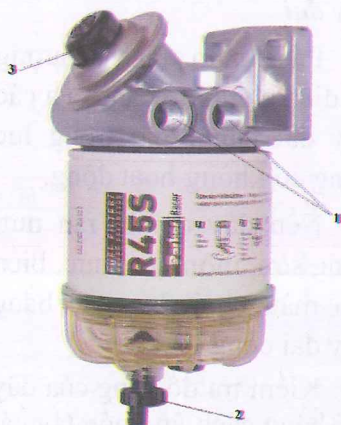
Hình 8.5. Lọc nhiên liệu 1- Đường nhiên liệu ra, vào; 2- Van xả nước; 3- Bơm tay.
