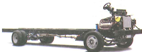
Hình 1.10. Hệ thống gầm xe tải
