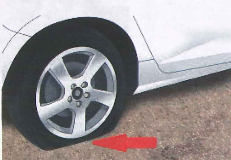
Hình 7.3. Bánh xe bị mất áp suất
