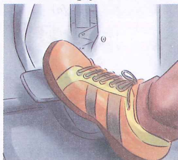
Hình 8.18. Kiểm tra bàn đạp phanh (a) Kiểm tra hành trình tự do; (b) Kiểm tra hành trình làm việc toàn bộ.
