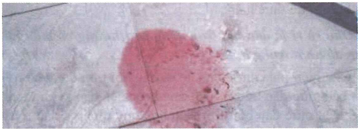
Hình 6.6. Dầu rò rỉ từ hộp số tự động
