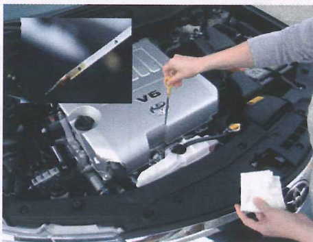
Hình 8.2. Kiểm tra mức dầu động cơ
