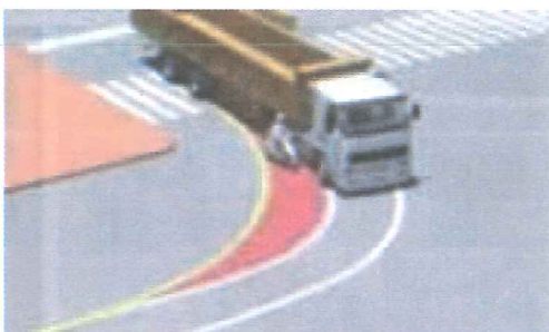
Hình 4-6: Va chạm khi xe máy đi vào vùng nằm trong quỹ đạo chuyển động của sơ mi rơ moóc.
