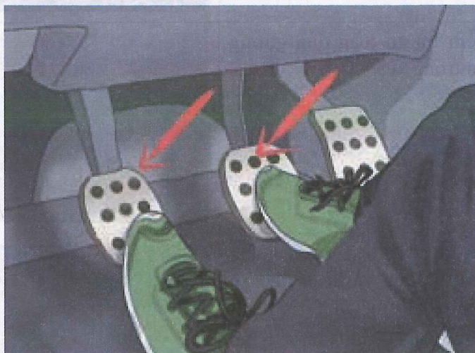
Hình 2-16: Đạp hết hành trình bàn đạp ly hợp và đạp bàn đạp phanh để dừng xe
