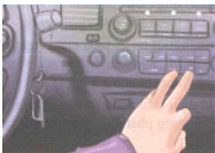
Hình 3-21: Tắt hệ thống điều hòa không khí
